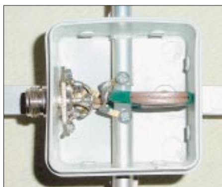
Bild 2: Anpaßleitung mit 75-Ω-Teflonkabeln RG 179 in der Strahlerdose
