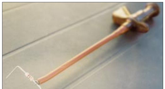
Bild 3: Die hohe Federkraft der Prüfklemme verhindert zuverlässig ein Wegdrehen des Bauelements; so gelangt es sicher zur Lötstelle.
