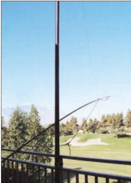
Bild 1: Die Antenne in der Praxis in W6 (Kalifornien), auf 10 m angepaßt
