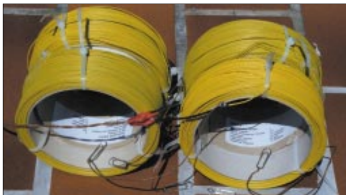
Bild 1: Die Empfangsantenne des Autors besteht aus vier Rollen Schaltdraht mit je 10,3 cm Durchmesser.
