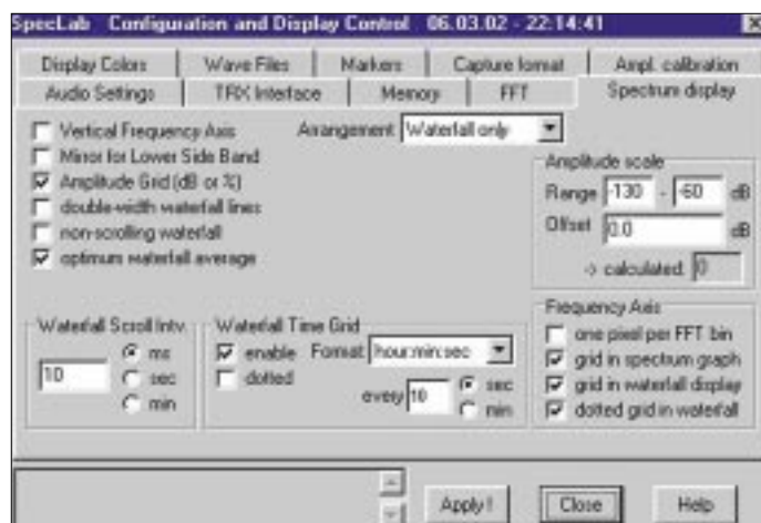
Bild 3: Über Options → Spectrum display gelangt man zu den Einstellmöglichkeiten für die Wasserfalldarstellung.
