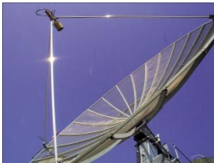
Der 10-m-Spiegel von HB9BBD in Mühlau überstand den schweren Sturm „Felix“ im Dezember vergangenen Jahres schadlos. Fotos: HB9BBD
