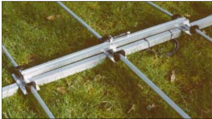
Bild 1: Die Phasenleitung des OB7-3. Mittig befindet sich die PL-Buchse zur Einspeisung. Unter dem Boom ist die Mantelwellendrossel aus Koaxialkabel zu erkennen.
