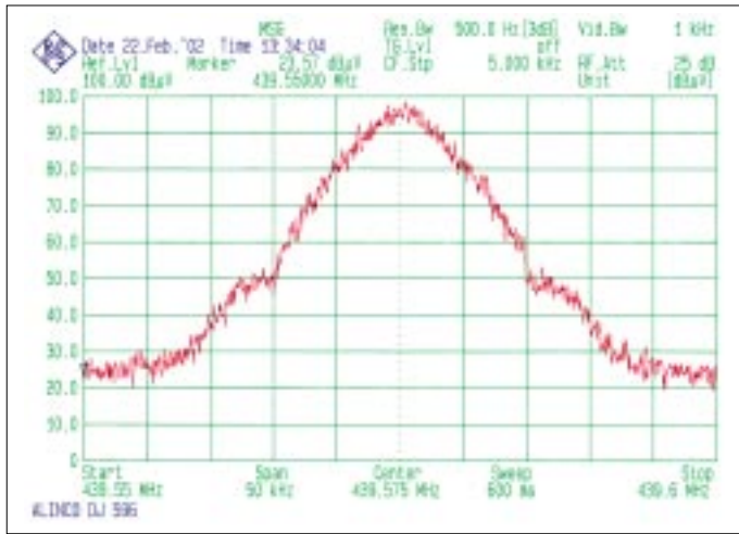
Bild 2: Auf dem Spektralanalysator präsentiert sich „Digital Voice“ wie ein ganz normales FM-Signal.
