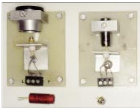
Bild 1: Ein Mikroskopokular für die Diode und zwei Laserdioden mit Kollimator
