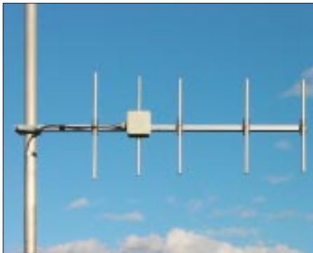
Bild 5: Vormastmontage bei der 5-Element-Yagi
