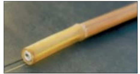
Bild 2: Ein weicher Schlauch passenden Durchmessers dient als Mutterhalter.
